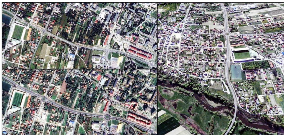
Rys. 4.22. Rozcięcie więzi – droga DK 82 przed i po przebudowie (dwukrotnie zwiększyła się szerokość korytarza drogowego)
